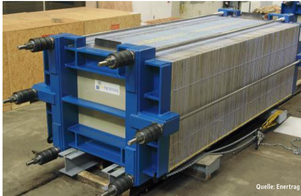
Abb. 9 Elektrolyse-Stack für das Hybrid- kraftwerk Prenzlau
