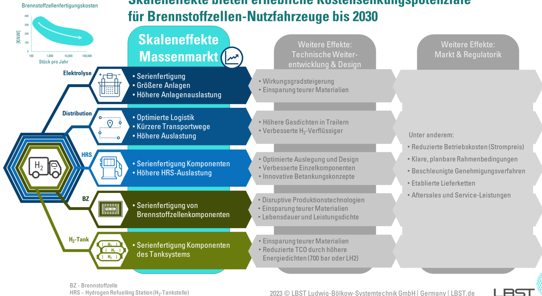
Abbildung 27: Übersicht wesentlicher Hebel zur Kostenreduktion von H 2 -BZ-Nfz durch Skaleneffekte sowie weitere Einflussparameter, eigene Darstellung
